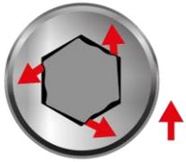
**Ultra HEX :** Grâce à la surface de contact hexagonale à 3 points et 3 faces, la fixation est optimale (version ULTRABALL). Sans dommage pour l'empreinte de la vis.
