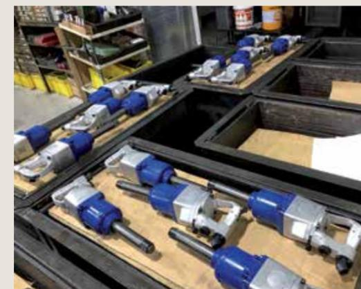
Juste un aperçu de l'assemblage de machines pneumatique sur des clés à choc, appareil qui est également décliné en puissante version thermique avec un moteur Maruyama. Pour construire tous les corps des machines, cet atelier dispose d'un centre d'usinage de l'aluminium (matière livrée en lingots). Ces machines pneumatiques et thermiques sont conçues, montées et vérifiées par Vessel.
