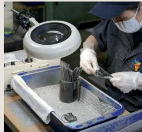
Les lames de tournevis sont vérifiées une par une à la sortie des machines d'usinage standard ou par échantillonnage lorsqu'elles proviennent de machines CNC.
