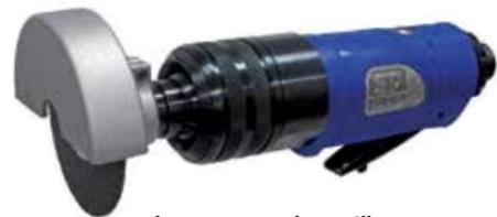
Les gammes des outils pneumatiques Vessel / SP Air se distinguent par leur grande qualité de fabrication et leur ergonomie, à l'image de la tronçonneuse SP-7231 dont la tête peut être orientée vers le haut et vers le bas sur un angle de 22,5° pour travailler dans les endroits difficiles d'accès. Sa vitesse de rotation est de 18 000 tr/min et son poids de 190 g.
