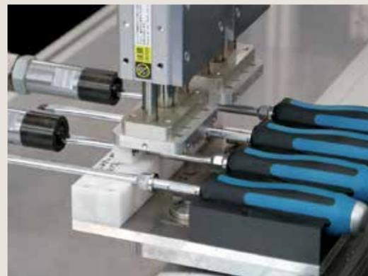
Pour les tournevis Megadora, la lame est insérée dans le manche déjà constitué. A noter que ces manches sont positionnés à plat pour le marquage afin que celui-ci soit impeccable et homogène.
