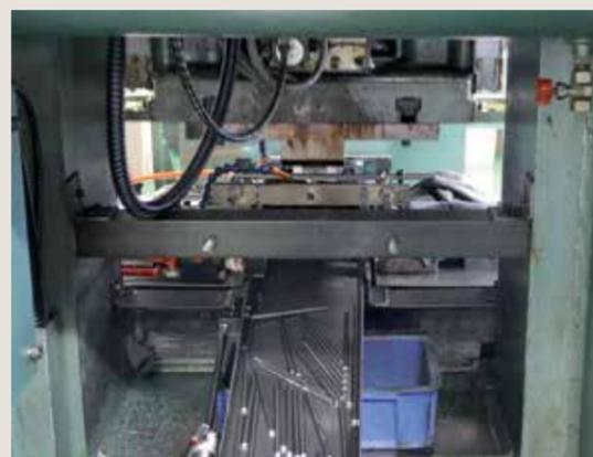
Les barres sont découpées avant d'être transférées vers les machines d'usinage.
