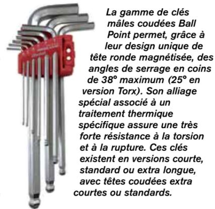
La gamme de clés mâles coudées Ball Point permet, grâce à leur design unique de tête ronde magnétisée, des angles de serrage en coins de 38° maximum (25° en version Torx). Son alliage spécial associé à un traitement thermique spécifique assure une très forte résistance à la torsion et à la rupture. Ces clés existent en versions courte, standard ou extra longue, avec têtes coudées extra courtes ou standards.
