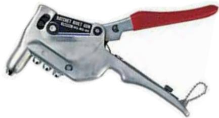
La pince à riveter RG-95 offre une grande facilité d'utilisation grâce à son système à crémaillère qui multiplie la puissance de traction et réduit l'effort à fournir. Elle permet de riveter d'une seule main des rivets jusqu'au diamètre 4.8 mm – elle est livrée avec des têtes de rivet 2.4, 3.2, 4.0 et 4.8 mm.
