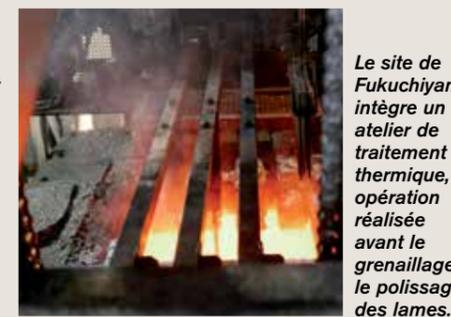
Le site de Fukuchiyama intègre un atelier de traitement thermique, opération réalisée avant le grenailage et le polissage des lames.
