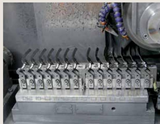
Pour la fabrication des pinces à dénuder, les deux branches en acier haut carbone de l'outil sont pliées sur des gabarits avant d'être usinées et serties ensemble (axe, ressort et ergot de blocage) après vérification de leur géométrie. Un dernier contrôle vient valider le sertissage puis des poignées en élastomère marquées dans les trois mesures AWG American Wire Gauge, mm et mm<sup>2</sup> sont enfilées sur les branches.
