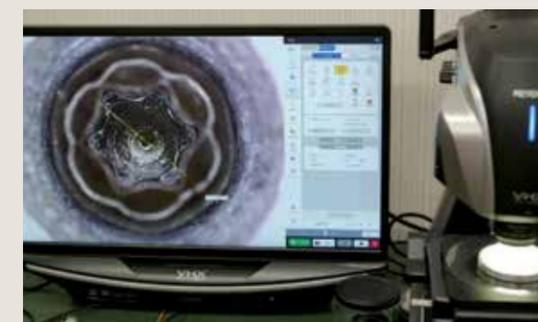
Empreinte de vis prise au microscope ; Vessel peut ainsi fabriquer l'embout qui correspond exactement à l'empreinte qui peut ne pas correspondre aux standards ou avoir été altérée.
