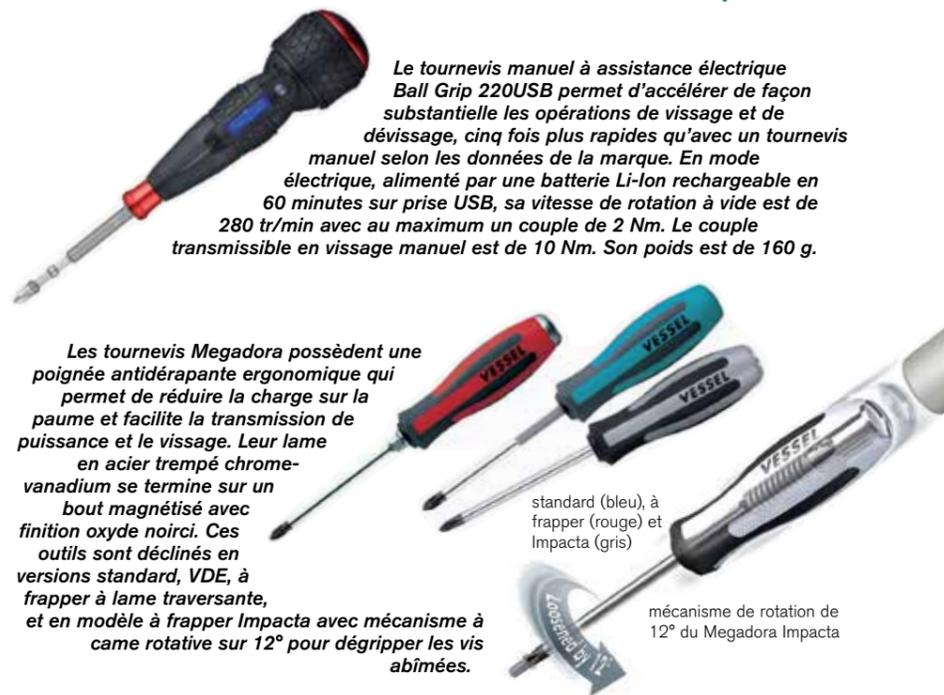
*Le tournevis manuel à assistance électrique Ball Grip 220USB permet d'accélérer de façon substantielle les opérations de vissage et de dévissage, cinq fois plus rapides qu'avec un tournevis manuel selon les données de la marque. En mode électrique, alimenté par une batterie Li-Ion rechargeable en 60 minutes sur prise USB, sa vitesse de rotation à vide est de 280 tr/min avec au maximum un couple de 2 Nm. Le couple transmissible en vissage manuel est de 10 Nm. Son poids est de 160 g.*
