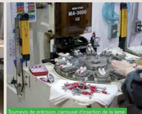
Tournevis de précision, carrousel d'insertion de la lame
